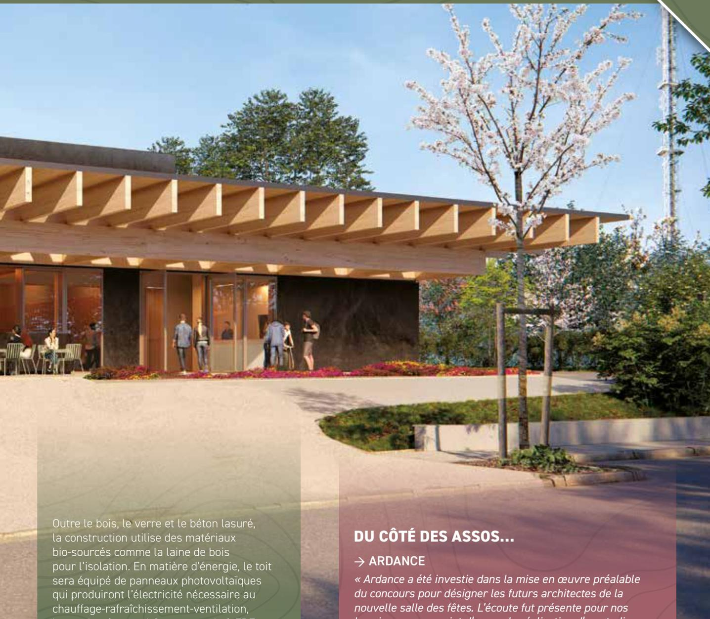
Outre le bois, le verre et le béton lasuré, la construction utilise des matériaux bio-sourcés comme la laine de bois pour l'isolation. En matière d'énergie, le toit sera équipé de panneaux photovoltaïques qui produiront l'électricité nécessaire au chauffage-rafraîchissement-ventilation, le surplus éventuel étant revendu à EDF.
